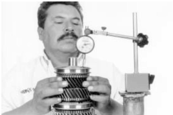
65.- Inspeccione el juego axial (.004"- .014") del engrane de 3ª. velocidad, se tienen cuatro espesores de seguros para seleccionar.
