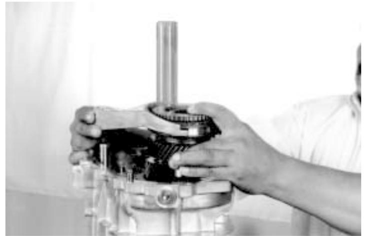
98.- Instale el conjunto sincronizador de 5ª. velocidad junto con la horquilla, como se muestra.
