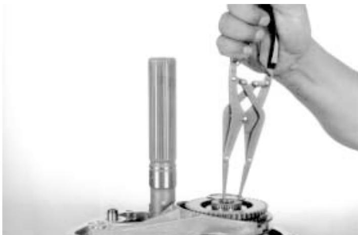
101.- Con una pinza para seguros, coloque el seguro del engrane de 5ª. del tren de engranes, como se indica.
