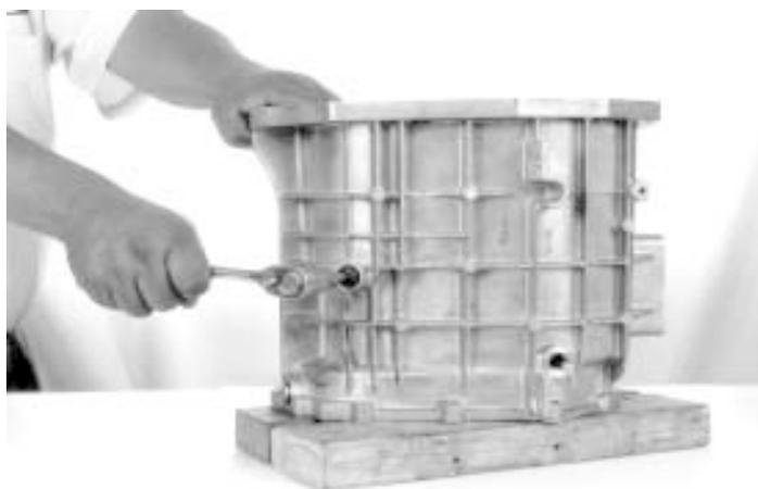
91.- Quite el tornillo del soporte del engrane de reversa con una llave tipo Torx 40, como se muestra.
