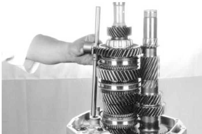
80.- Coloque la barra selectora de velocidad, como se indica.
