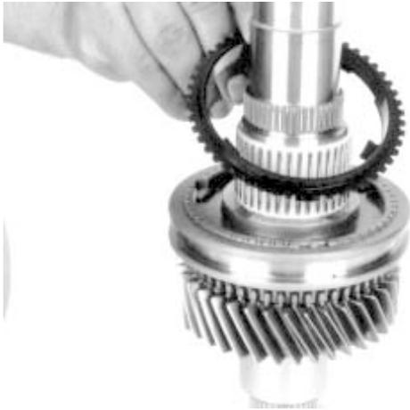
24.- Instale el anillo sincronizador del engrane de 1ª. velocidad, como se muestra.
