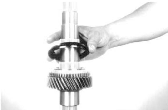
20.- Instale el anillo sincronizador del engrane de 2ª. velocidad, como se muestra.
