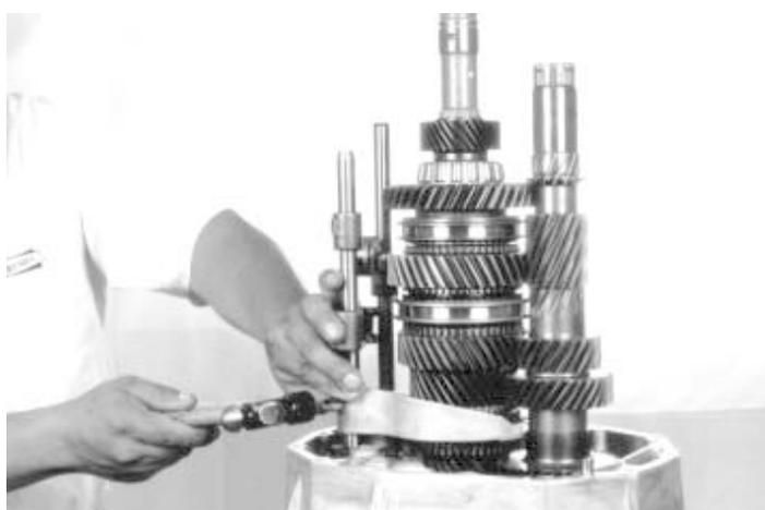
82.- Con ayuda de un martillo coloque el perno seguro de la horquilla en la barra de cambio de 3ª. y 4ª., como se indica.
