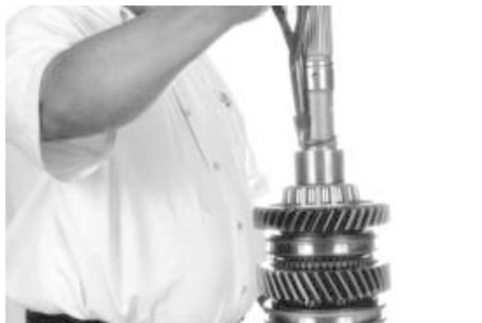
41.- Con una pinza para seguros, instale el seguro del buje, como se muestra. Solo para transmisiones de 4 velocidades
