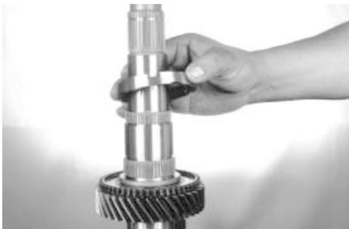
18.- Instale el anillo interior del engrane de 2ª. velocidad, como se muestra.
