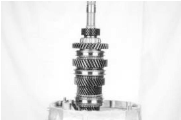
61.- Coloque el arreglo del árbol primario, como se muestra.
