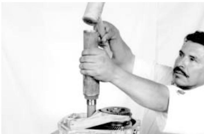
103.- Ayudado de una herramienta impulsora Instale el engrane velocímetro, como se indica.
