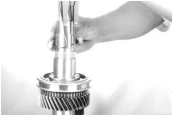
65.- Con una pinza para seguros, quite el seguro que sujeta la maza del sincronizador,
