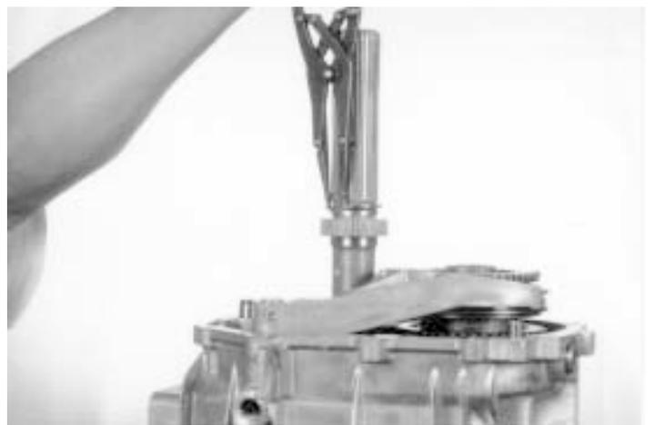
10.- Con una pinza para seguros, quite el seguro que sujeta el engrane velocímetro.
