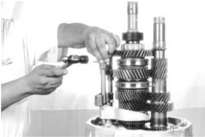
83.- Con ayuda de un martillo coloque el perno seguro del tope en la barra de cambios de 3ª. y 4ª., como se muestra.
