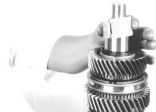
43.- Gire el conjunto primario y coloque la jaula de rodillos del engrane de 3ª. velocidad, como se indica.
