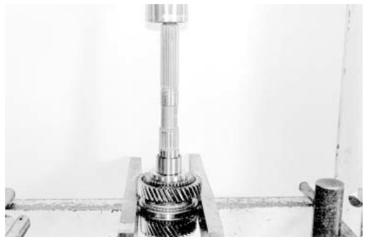
58.- Ayudado de una prensa o de una herramienta impulsora, saque el bujedo del engrane de reversa, como se indica.
