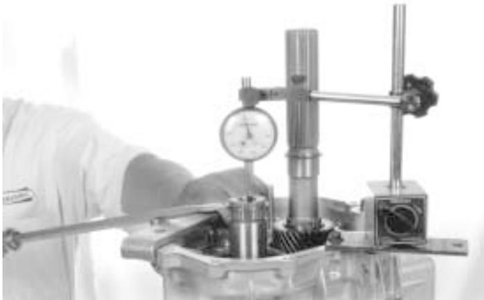
73.- Inspeccione el juego axial (.001"-.005") del tren de engranes
