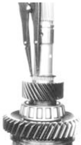
42.- Con una pinza para seguros, coloque el seguro del engrane de 5ª. velocidad, como se muestra.
