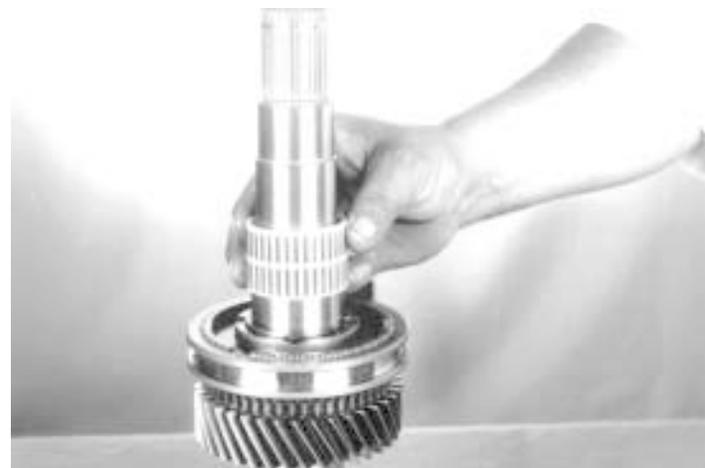
23.- Instale la jaula de rodillos del engrane de 1ª. velocidad, como se indica.
