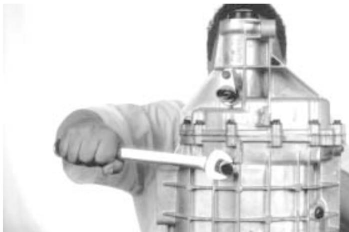
4.- Coloque la Transmisión como se muestra, sobre dos maderas y quite el interruptor de reversa.
