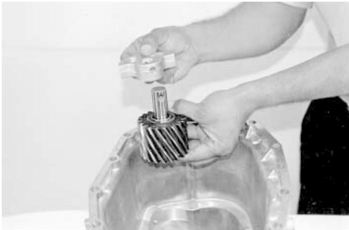
3.- Arme el conjunto de reversa y coloque el soporte, como se muestra.
