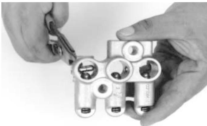
9.- Con la ayuda de unas pinzas coloque los (2) émbolos de encastramiento, como se indica.
