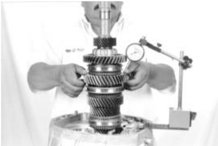
63.- Inspeccione el juego axial (.008"- .016") del engrane de 1ª. velocidad, como se muestra.
