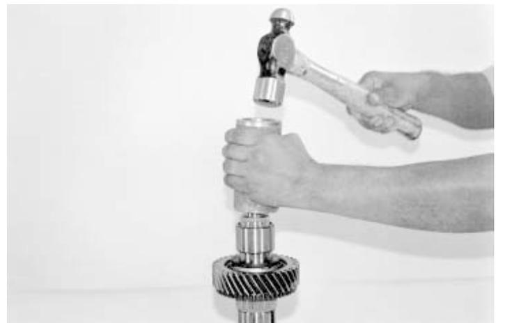
17.- Ayudado de una prensa o una herramienta impulsora, coloque el buje del engrane de 3ª. Vel. como se indica.
