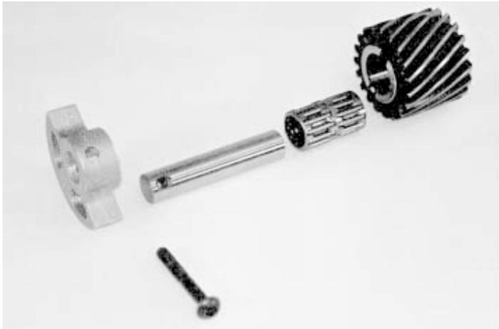
1.- Arreglo del conjunto de la reversa y soporte, muestra jaula de rodillos, engrane de reversa y tornillo.
