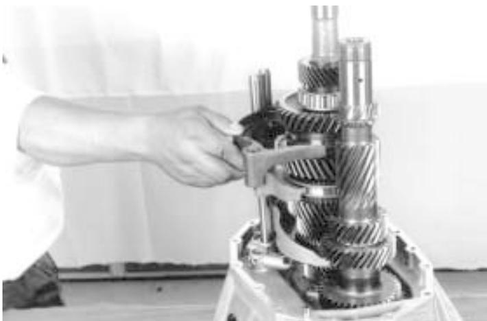
87.- Coloque la horquilla de reversa, como se muestra.
