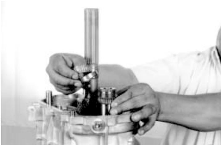
97.- Coloque los dos baleros de rodillos y el espaciador, como se indica.
