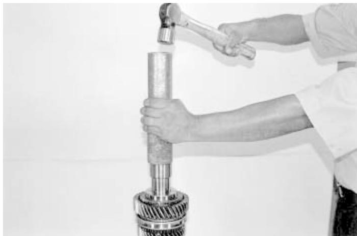
31.- Ayudado de una prensa o una herramienta impulsora, instale el buje del engrane de reversa, como se indica.
