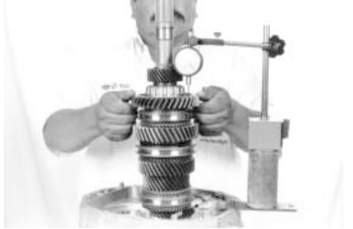
62.- Inspeccione el juego axial (.004"- .014") del engrane de reversa, como se indica.
