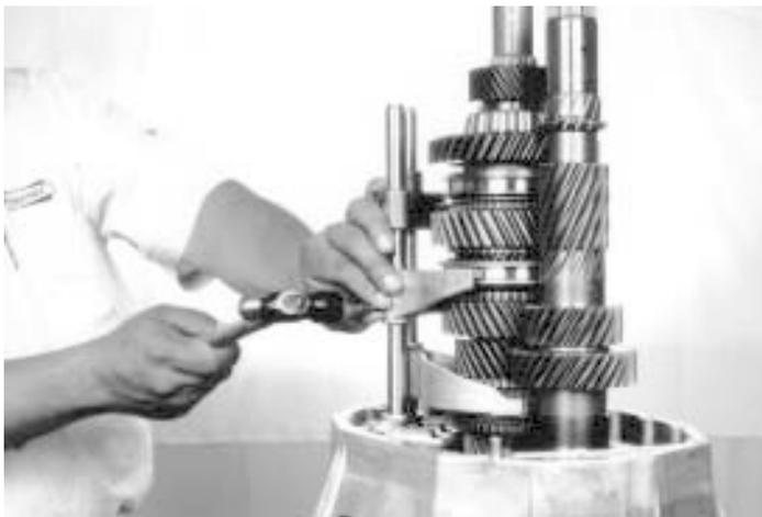
85.- Con ayuda de un martillo coloque el perno de la horquilla en la barra de cambios de 1ª. y 2ª., tenga cuidado con el perno de encaste que va en la barra
