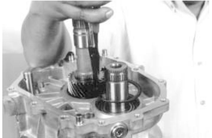
72.- Con una pinza para seguros, instale el seguro que sujeta la taza balero del tren de engranes.
