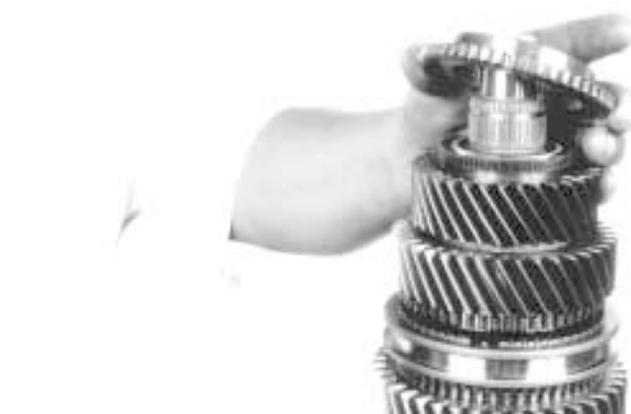
45.- Coloque el cono del engrane de 3ª. velocidad, como se indica.
