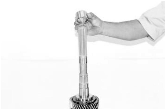
30.- Guíe el buje del engrane de reversa, como se indica
