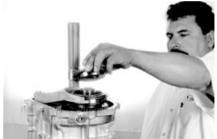
100.- Instale el cono de embrague del conjunto sincronizador de 5ª. velocidad, como se muestra.
