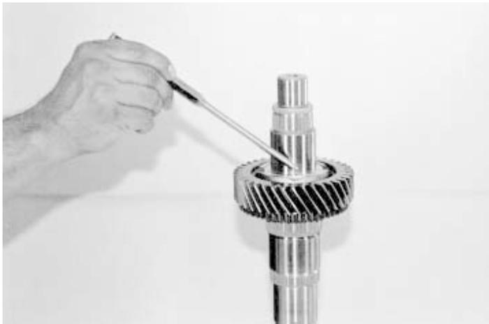
14.- Coloque el engrane de 2a. Vel., y con ayuda de un imán instale la esfera de arrastre como se indica.
