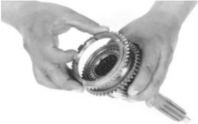
59.- Coloque el anillo sincronizador de la flecha de mando, como se muestra.
