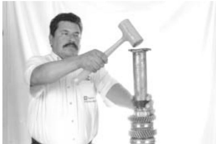
39.- Ayudado de una prensa o una herramienta impulsora, instale el engrane de 5ª. velocidad.
