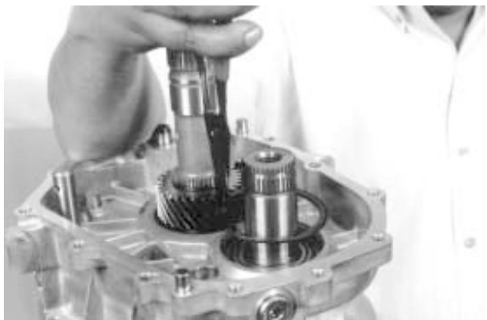
94.- Con una pinza para seguros, instale el seguro que sujeta la taza balero del tren de engranes.
