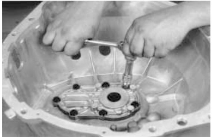
52.- Coloque temporalmente los (7) tornillos del retén balero con un dado de 13 mm. En la campana de embrague.
