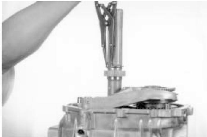
104.- Con una pinza para seguros instale el seguro que sujeta el engrane velocímetro.
