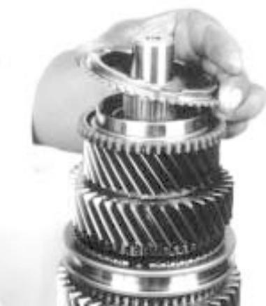
46.- Coloque el anillo sincronizador de 3ª. velocidad, como se muestra.
