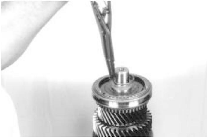
48.- Con una pinza para seguros, coloque el seguro de la maza del sincronizador de 3ª. y 4ª., como se muestra.
