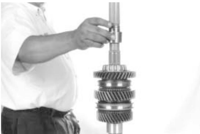
40.- Si la transmisión es de 4 velocidades coloque el buje en lugar del engrane de 5ª. velocidad, como se muestra.
