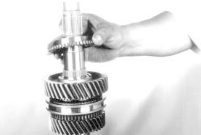
28.- Coloque el cono de embrague del conjunto engrane de reversa, como se muestra.
