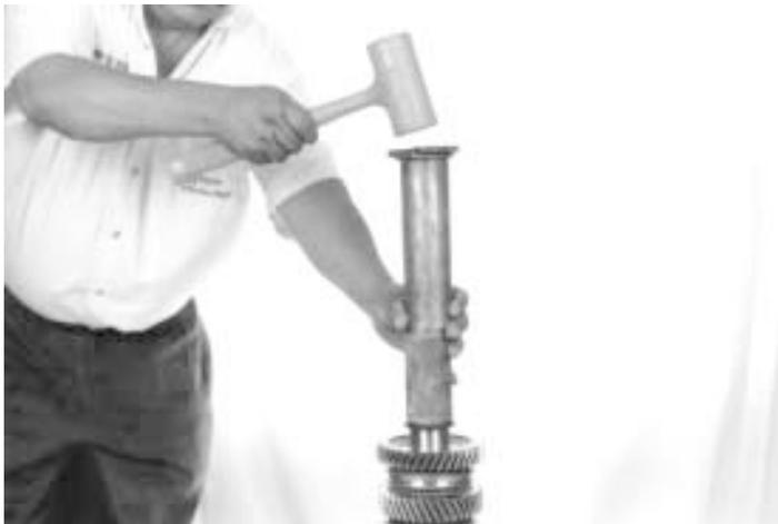
36.- Ayudado de una prensa o una herramienta impulsora coloque el buje del conjunto engrane de reversa, como se muestra.
