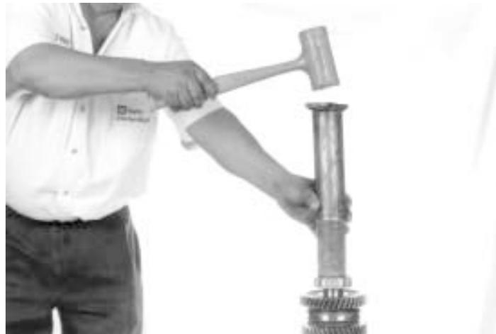
37.- Con la misma prensa o herramienta impulsora coloque el cono balero, como se indica.
