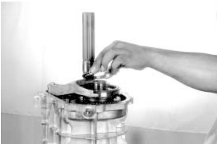
99.- Coloque el anillo sincronizador, como se indica.
