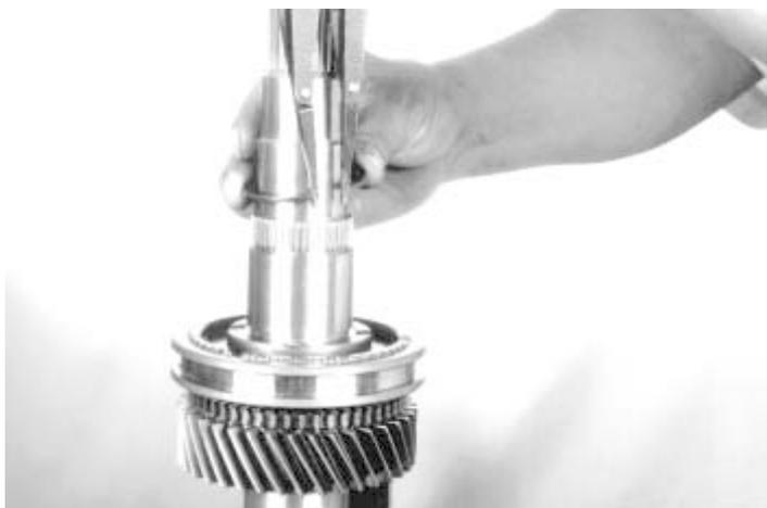
22.- Con una pinza para seguros, Instale el seguro que sujeta la maza del sincronizador de 1ª. y 2ª., como se muestra.
