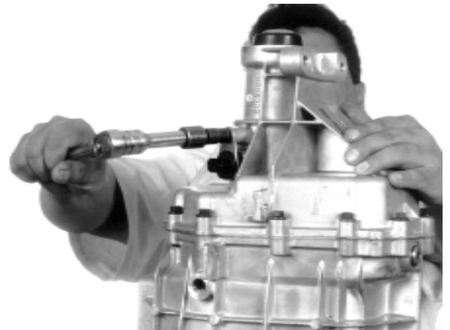
110.- Con un dado de 10 mm apriete el tornillo del sensor del velocímetro al troqué recomendado (12-16 lb-ft)
