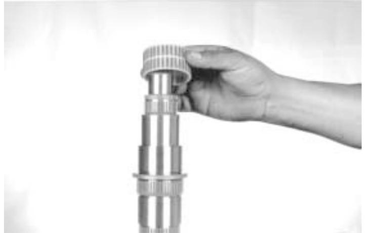
13.- Instale la jaula de rodillos del engrane de 2ª. velocidad, como se muestra.
