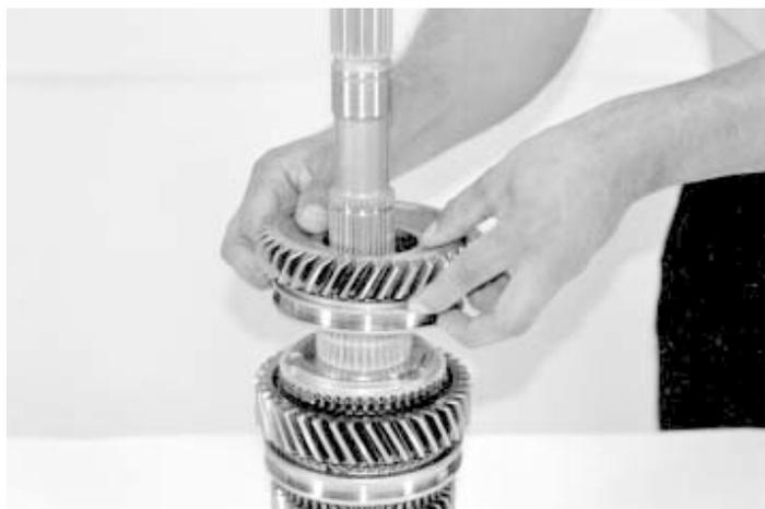
33.- Coloque el conjunto engrane de reversa, como se muestra.
