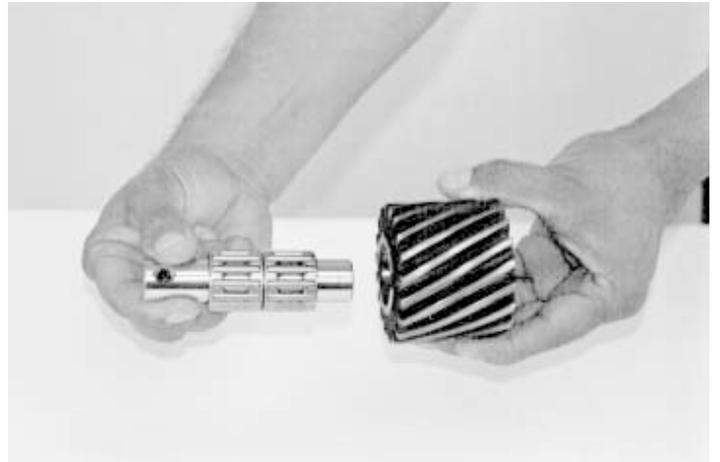
2.- Coloque la jaula de rodillos dentro del engrane, como se indica.
