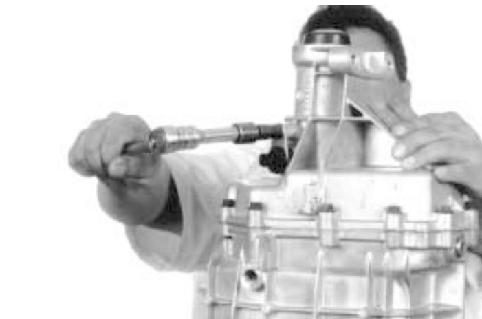
5.- Quite el sensor del velocímetro, con un dado de 10 mm.
