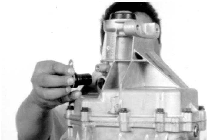
109.- Coloque el sensor del velocímetro como se muestra.
