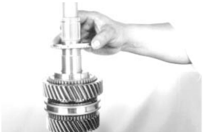
29.- Instale el anillo sincronizador del conjunto engrane de reversa, como se indica.
