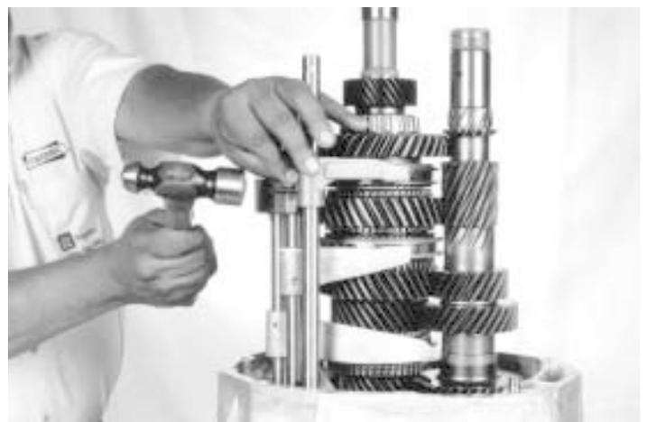
88.- Con ayuda de un martillo coloque el perno de la horquilla en la barra de 5ª. y Reversa, como se indica.
