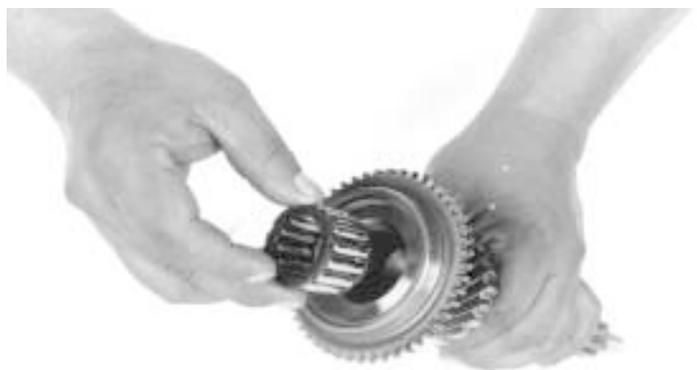
57.- Instale la jaula de rodillos del interior de la flecha de mando, como se muestra.
