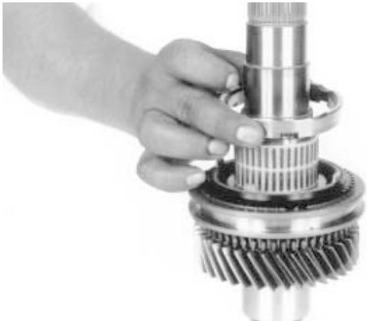
26.- Instale el cono interior del engrane de 1ª. velocidad, como se muestra.
